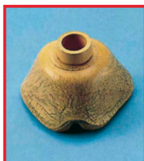
Трещина старения на респираторной маске
