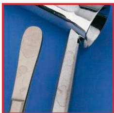
Пятна вследствие высокого содержания соли в воде для полоскания
