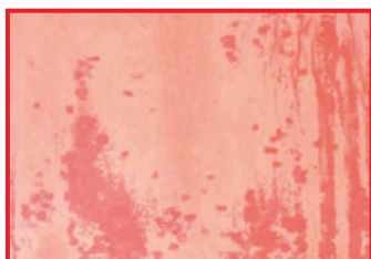
Видимые изменения анодированного алюминия уже при незначительном содержании щелочи
