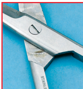
Фрикционная коррозия вследствие не выполнения смазки
