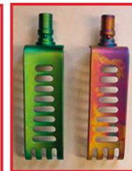
Выборка – шины из титана: Левая шина – новая, с завода. Правая шина – после машинной мойки. Обычно окраска изменяется равномерно. Однако она может быть и в виде пятен/различного цвета.
