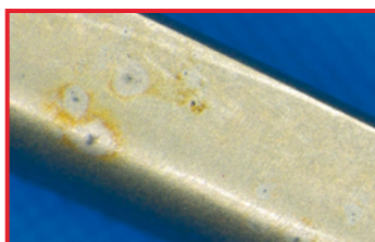
Индукцированная хлором питтинговая коррозия на инструменте
