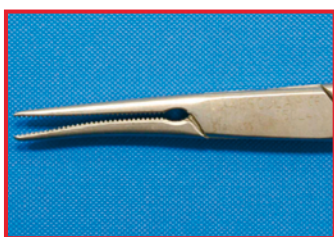
Деформация вследствие неправильного применения
