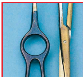
Окрашенные под действием кремниевой кислоты инструменты
