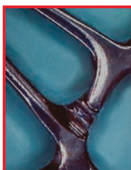
Раневой крючок с окрашенным в черный цвет стержнем из закаленной Cr-стали и оставшаяся чистой рукоятка и лист из незакаленной CrNi-стали
