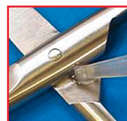
Предотвращение: целенаправленный уход с использованием инструментального масла
