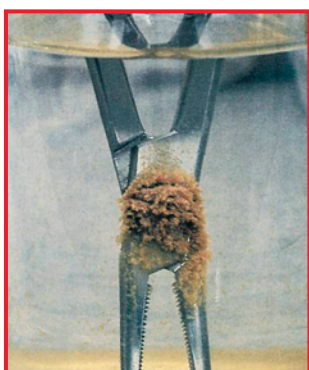
Образование ржавчины после многочасового погружения в физиологический солевой раствор
