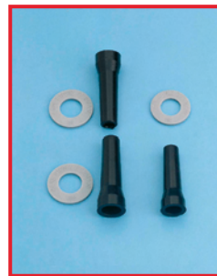
Справа: разбухшее уплотнение вследствие неточного нанесения инструментального масла. Слева: новые уплотнения
