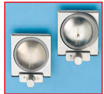
Справа: негерметичный откидной клапан троакара вследствие разбухания уплотнения из-за контакта с маслом. Слева: новый откидной клапан
