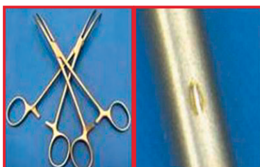
Контактная коррозия: нержавеющая сталь/ нержавеющая сталь
