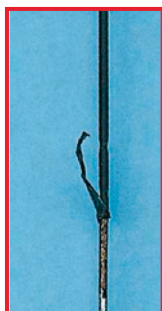
Нарушенная изоляция ВЧ инструмента
