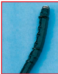
Разбухание подающего шланга вследствие использования неподходящего средства для ухода.
