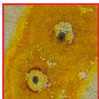
Хлорсодержащая регенерированная соль вызвала массивную питтинговую коррозию на поверхности инструмента. Причина: негерметичное подключение ионообменника в аппарате для мойки и дезинфекции (АМД).
